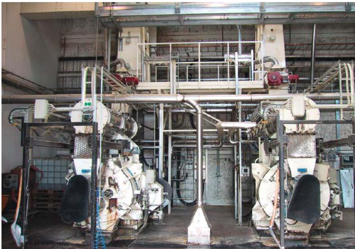
Рис. П 3.8. Прессы для производства пеллет на технологическом участке: производительность прессы 3-8 т/ч; энергоемкость операции 20-60 кВт·ч/т при плотности получаемых пеллет 400-700 кг/м 3
